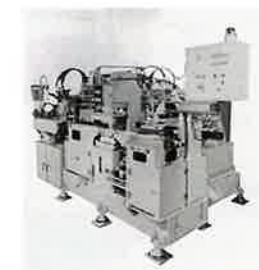
電源コード製作自動機
